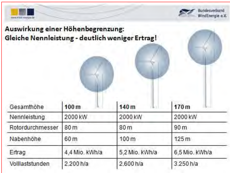
Abbildung 37: Ertragsveränderungen durch unterschiedliche Nabenhöhen bei Windkraftanlagen [13]
