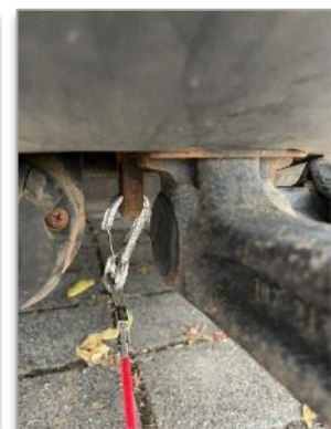
Bild 13: Karabinerhaken der Sicherheitsbremse am Fahrzeug einhängen
