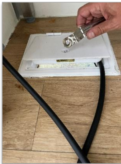
Bild 2: Öffnen und Schließen der Bodenklappe mit 4-Kant-Schlüssel
