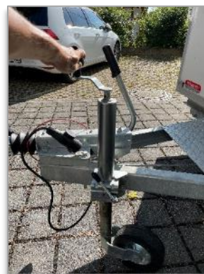
Bild 12: Rangierhilfe absenken, Befestigung Anhänger- kupplung feststellen
