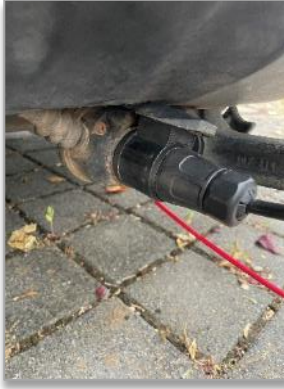
Bild 14: Elektrostecker am Fahrzeug befestigen
