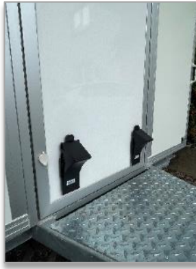
Bild 20: Spülmobil mit den Sicherungskeilen gegen wegrollen sichern.
