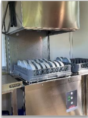
Bild 29: Geöffnete Haube des Spülmobils mit Spülgut
