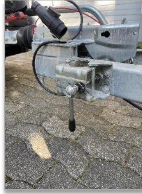
Bild 16: Halterung für Rangierrad wieder schließen und festschrauben
